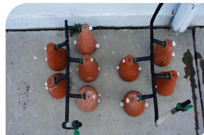
Se diseño un sistema de riego por subirrigación con capsulas porosas para evaluar su funcionamiento en diferentes sustratos con diferentes tamaños de partículas.
