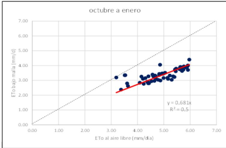
Figura 3. Evapotranspiración de referencia (ETo) al aire libre y bajo malla.
